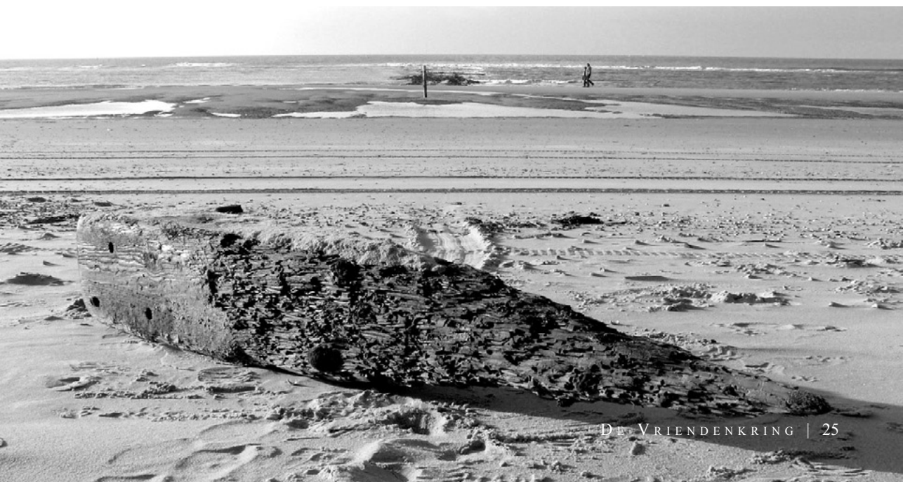
Figuur 3: een volledig aangetaste dikke paal aangespoeld op het strand.
