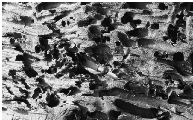
Figuur 4: goed is te zien dat de paal geen enkele sterkte meer had toen hij in zee verdween.
