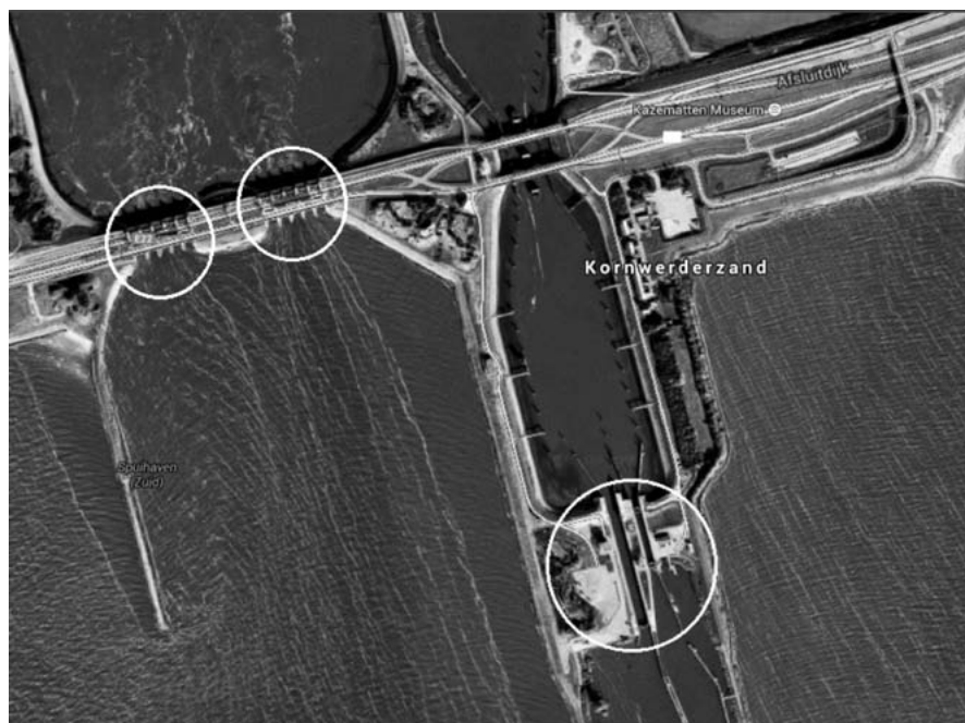
De Lorentzsluizen bij Kornwerderzand; Omcirkeld links: de 8 spuisluisen; Onder omcirkeld: de twee schutsluisen. Bron: Google Maps
