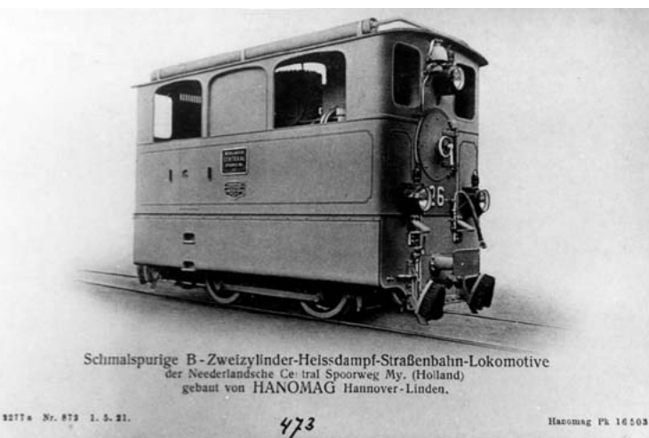
De twee-cilinder smalspoor stoomlocomotief werd gemaakt door de firma Hanomag in Duitsland. Bron: privé collectie.
