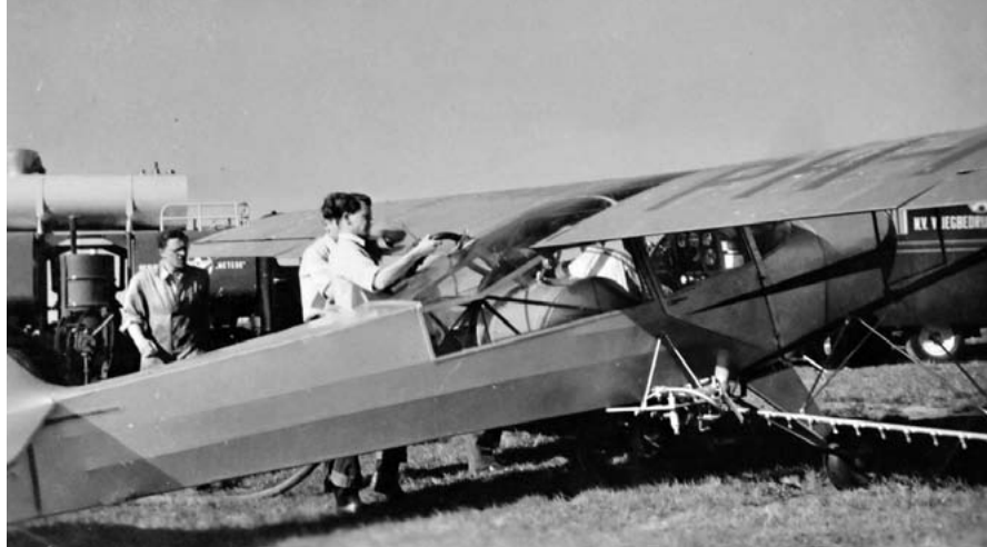
Het voltanken van een sproeivliegtuig. Rechts laag onder de vleugel is de sproeileiding met de spuitkoppen te zien. Foto: Archief Hans Veenhuis
