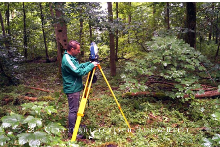
Onderdeel van de meetopstelling met de naam "Total Station". Foto: Evert de Boer.
